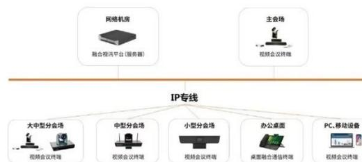
平治东方融合视频会议系统创新地将传统视频会议终端、移动手机端、PC 电脑端、会议平板、个人桌面端、PSTN 电话、IP 电话等接入到一个平台，为各级政企单位提供便捷、高效、畅通的视频会议服务。
