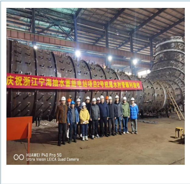
公司负责的浙江宁海抽水蓄能电站项目2号机尾水肘管顺利验收。
