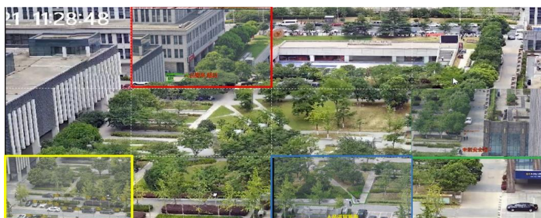
阵列相机示意图：由多个画面拼接，实现对特定焦段的清晰观测（即方框内画面），方框外画面无法进行细节放大
