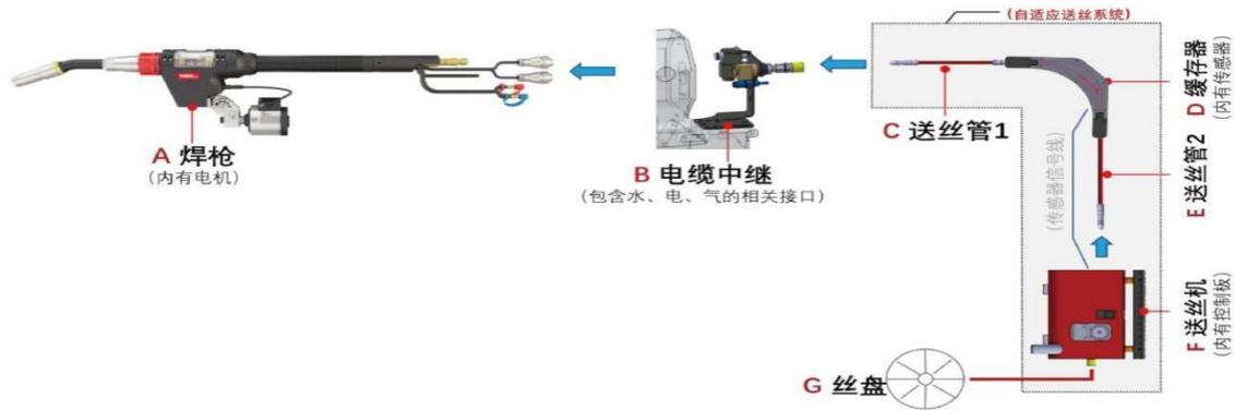
自适应送丝技术主要为满足对焊丝具有高频动态响应特性（抽拉焊丝频率最高可达 120HZ）的焊接工艺，亦可匹配支持 CMT 焊接工艺的焊机。应用该工艺所焊接的产品具有一致的熔深和均匀的焊缝外观，且工件热变形量较小；同时，在焊接薄板或超薄板时不易出现塌陷或焊穿的情况。
