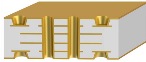
化学沉铜后 (孔壁绝缘基材覆盖铜)
