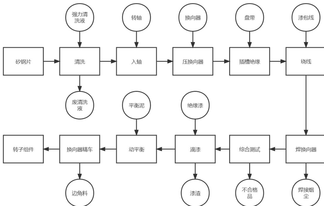
(4) 总装生产工艺流程
