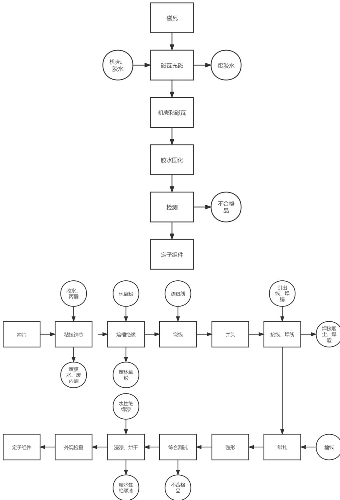
(2) 机加工生产工艺流程
