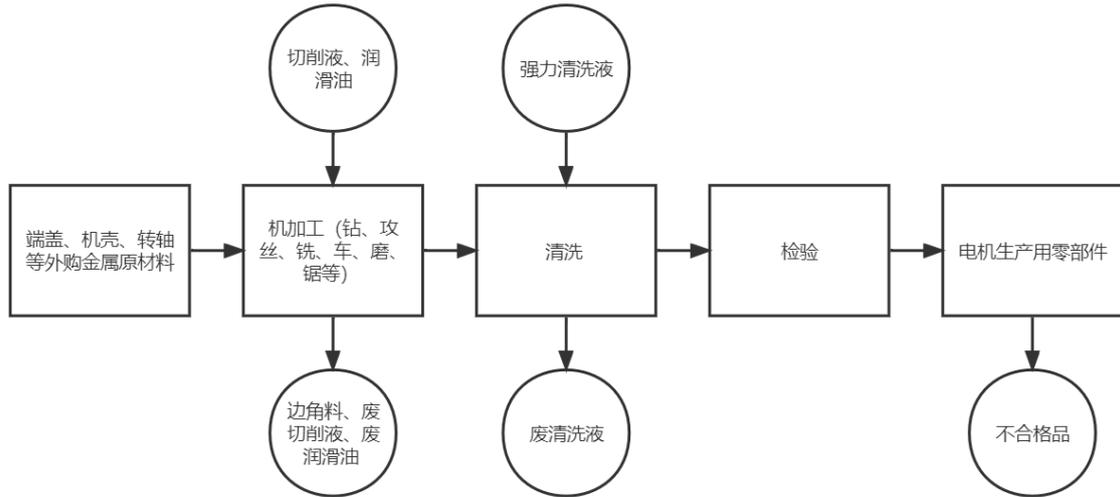
(3) 转子组件生产工艺流程
