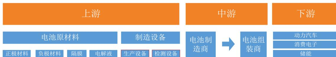
锂电池设备主要应用于产业链中游，功能覆盖锂电池制造环节，与锂电池产量息息相关。而公司主要产品为锂电池极片测量设备、锂电池真空干燥设备与 X-Ray 成像检测设备三类，其中锂电池极片测量设备应用于涂布和辊压工艺；干燥设备则用于电芯注液前的烘干工艺；X-Ray 成像检测设备则应用于电芯卷绕/叠片和入壳工艺。
