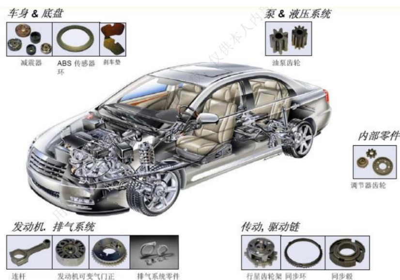
汽车中粉末冶金零件的大体分布
