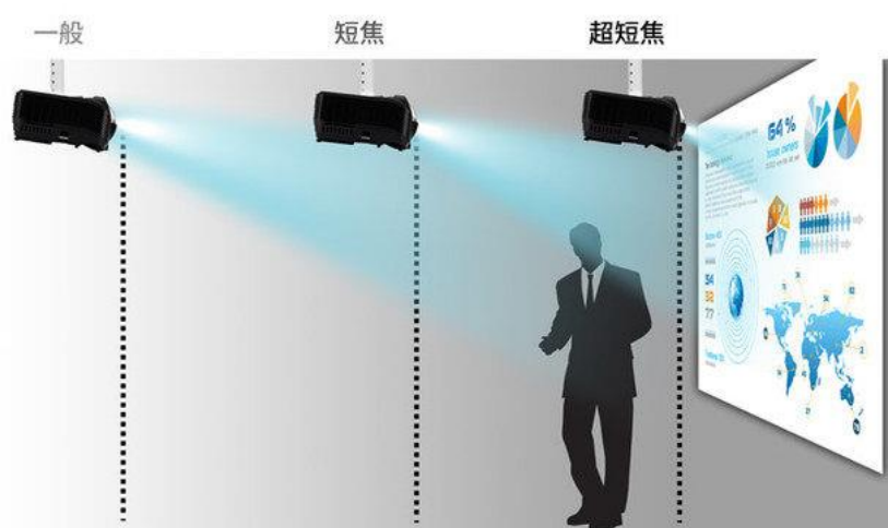
图：采用不同焦距镜头的投影设备示意
