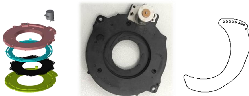
图：虹彩光圈结构与叶片结构 2D 图
