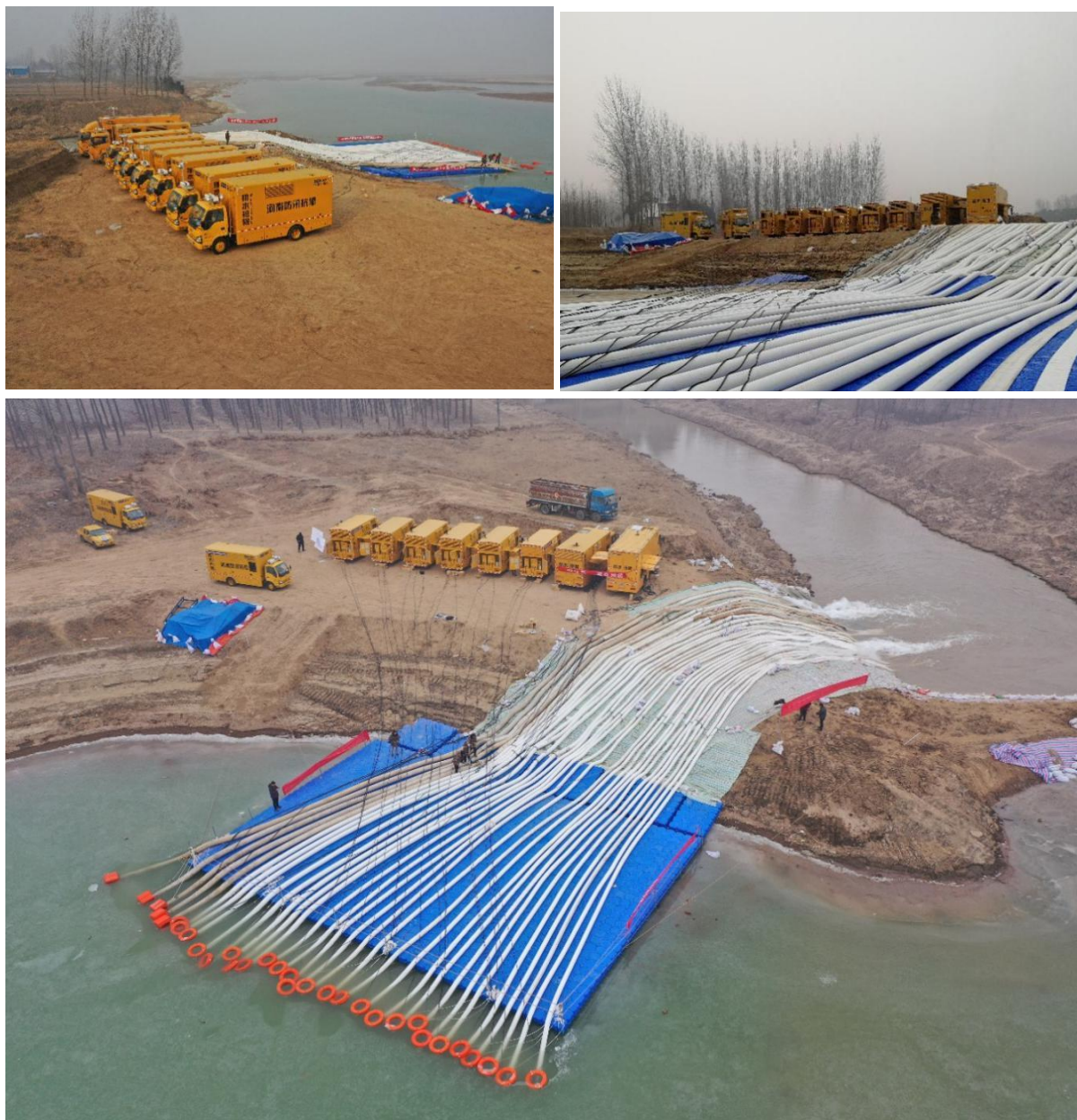
图示：2019 年初，河南省防汛抗旱指挥部实施了河南沿黄引水史上第一次大规模应急调水，由河南省防办八辆迪沃 1200 型排水车和迪沃紧急驰援的 4000 型、5000 型两辆迪沃排水车集群组建了临时泵站，20 天内调水 550 万立方，保障了商丘市民的安全饮水。
