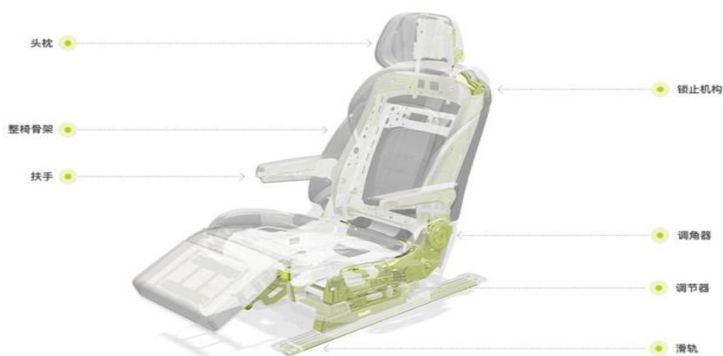
汽车座椅结构图
