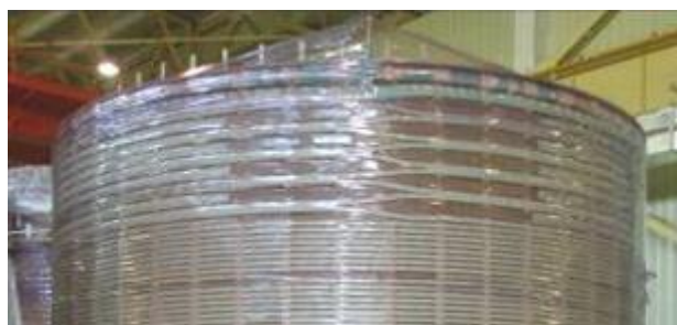
绕制成线圈的阶梯状组合换位导线
