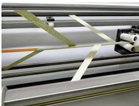
生产中的漆包纸包组合导线
