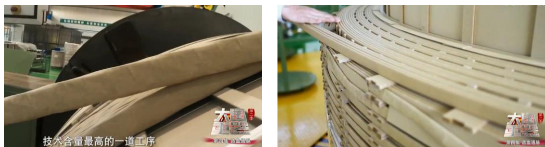
公司电磁线产品绕制线圈的过程（特变电工工厂）
