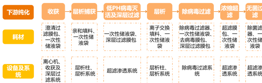
生物药分离纯化流程示意图
