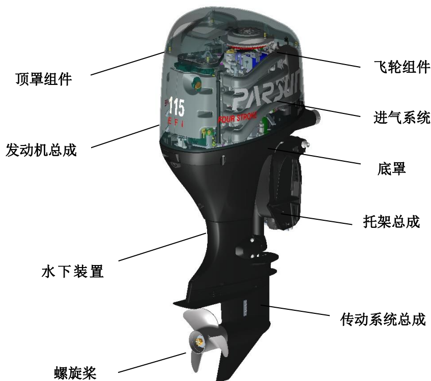
公司 115 马力舷外机产品结构图示
