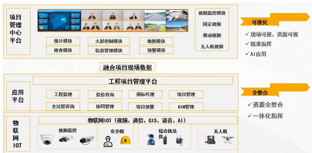
公司数字化系统平台的物联网 IOT，主要包括：移动单兵设备（4G 执法仪、4G 安全帽、智能眼镜）、工地视频（布控球）、图文扫描仪硬件、无人机等，需要与公司自研的数字化系统进行定制化开发接入，然后通过公司数字化平台将业
