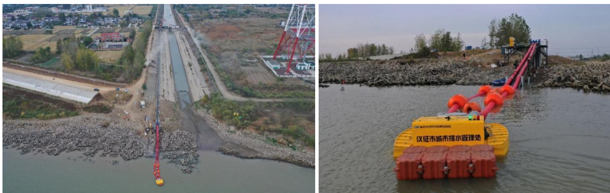
图示：2019-2021 年仪征胥浦河闸泵站改造期间，两辆迪沃 5000 型水陆两栖移动泵站
