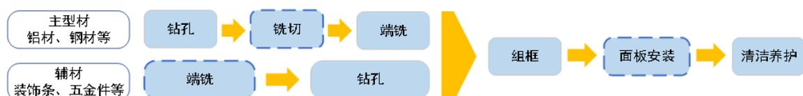
注：虚框为单元式幕墙特有环节，构件式幕墙无此环节。
