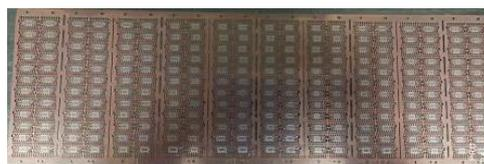
SOP 16L 的 12 排引线框架
