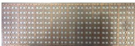
SOP 8L 的 8 排引线框架
