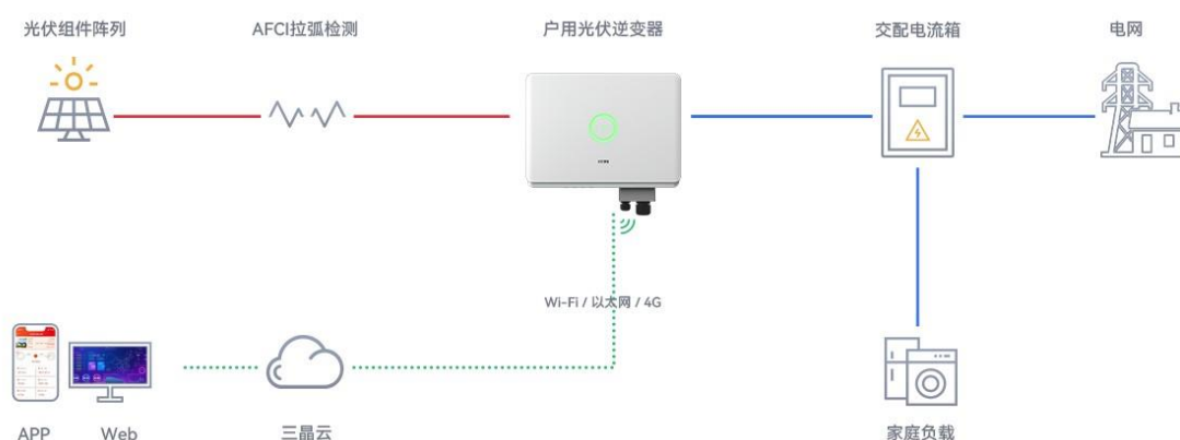
户用光伏并网逆变器系统应用图示
