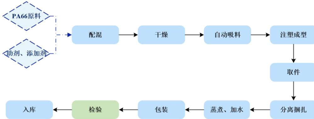
公司注塑车间将 PA66、助剂、添加剂等原材料放入拌料机进行配混，配料干燥后由供料系统自动吸料进入注塑机，经注塑机注塑成型后，产品由人工进行扎带分离并捆绑包装，并进行蒸煮调湿。干燥后进入包装车间进行打包，抽检后入库。
