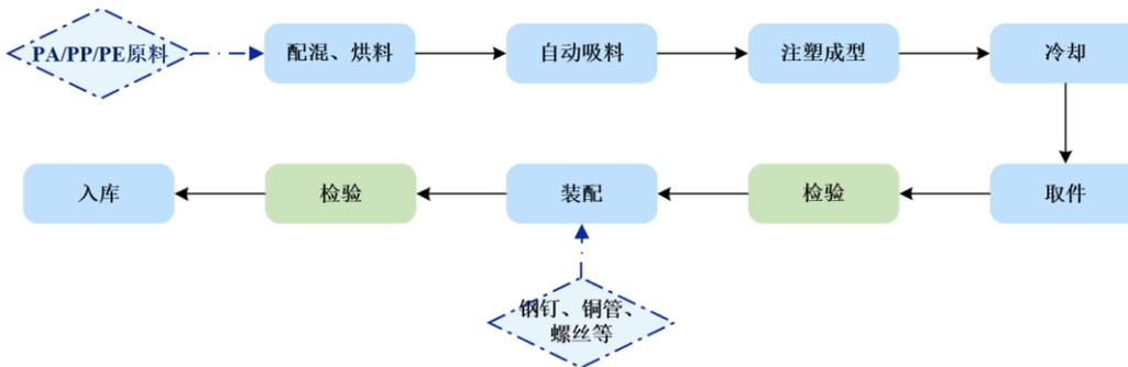
公司注塑车间将 PA、PP、PE 等原材料放入拌料机进行配混，烘料后由供料系统自动吸料进入注塑机，经注塑机注塑、成型冷却后，进行取件、检验，合格产品进入装配车间，根据产品装配钢钉、铜管、螺丝等零件后打包，抽检后入库。
