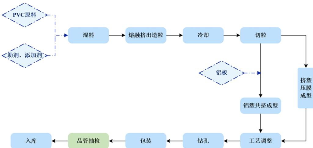
公司挤塑车间将 PVC、助剂、添加剂等原材料进行混料并形成造粒，经冷却后进行切粒，根据客户
