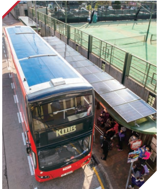
▲ 巴士車頂裝置太陽能板已成為九巴新購巴士的基本裝置
