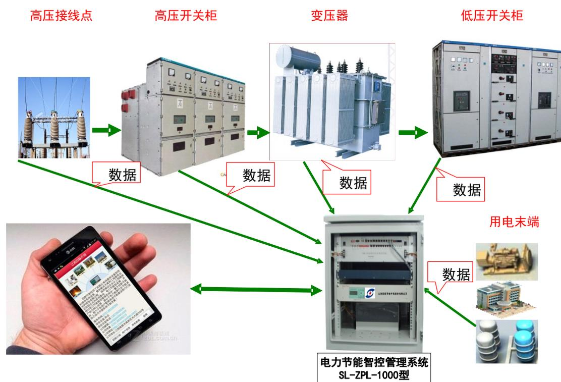
首先，实时监控可对非用电时段异常值监控，用户可及时采取措施降低用电量；其次，通过对变压器损耗、配电线路损耗、居民用电网损耗进行统计分析和多层面的对比分析发现用户能源浪费的漏洞，挖掘能效提升空间，及时查找出电
