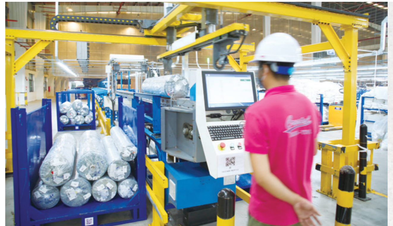
在我們的牛仔服工廠，由供應商交付的布卷以機器分類並放置於不同的貨架裏，以便運送到相應的崗位進行生產。
