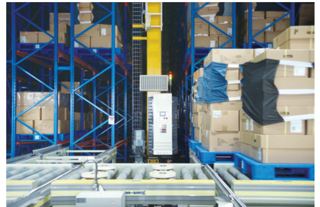
我們將廢棄彈性布料，循環用作固定卡板上的貨物，取代即棄塑膠薄膜。
