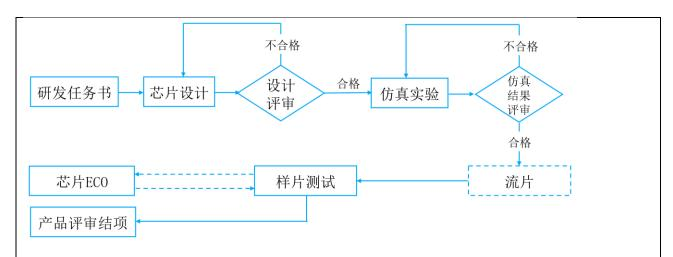
针对芯片产品的研发流程,公司主要参与的关键技术节点介绍如下:
