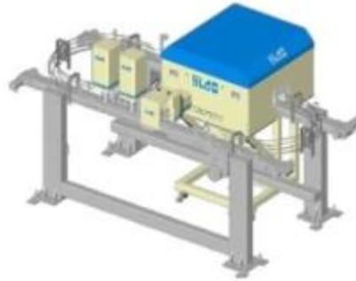
易拉罐检测设备
