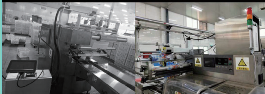
多支裝枕式包裝機台雙光電跟蹤改造
