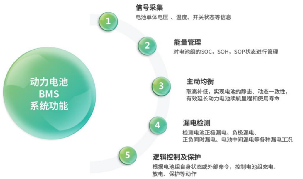
动力电池 BMS 系统的功能图
