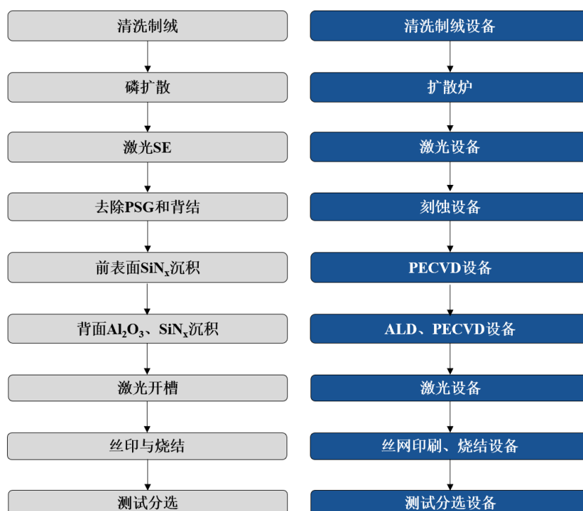
P 型 PERC 制备工艺流程图及对应设备
