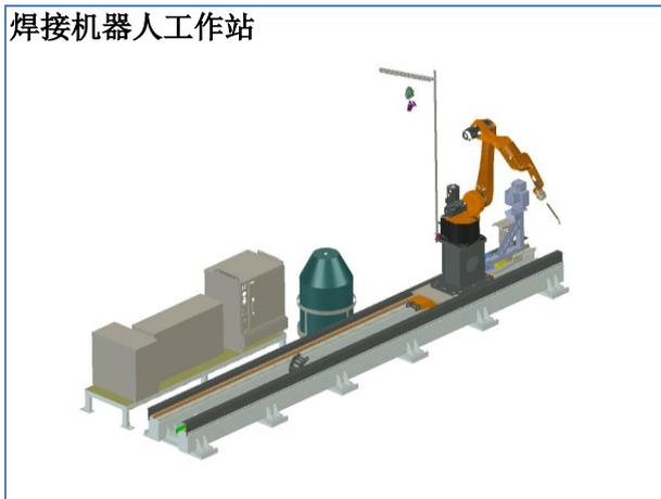
由伺服电机驱动机器人在轨道上行走，并自动调取对应的焊接程序，实现机器人的自动焊接
