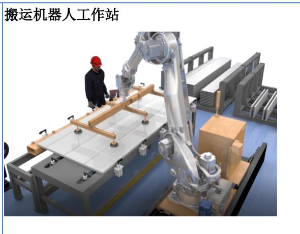
通过真空吸附作用，机器人将加工件吸附起来，并将其精准移动到相应位置
