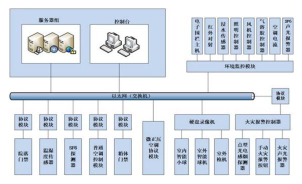
以发行人与青岛特锐德电气股份有限公司(以下简称"青岛特锐德")的变电站智能辅控系统业务为例,相关设备包括室内摄像机、硬盘录像机、协议接口板、SF6 相关设备(主机、传感器、协议接入模块、声光警示系统等)、8口交换机等。相关业务合同约定该项目应达到的功能标准包括"系统应有良好的可扩展性能与变电站的图像监视系统、环境监控系统兼容联动"、"实现安防、消防、视频、SF6、环境监控系统融合,集成在一个平台上,实现安防、消防、视频、SF6、环境的报警联动、录像等功能"、"系统软件采用组态技术,工业实时数据库与关系型数据库结合的数据处理技术"。
