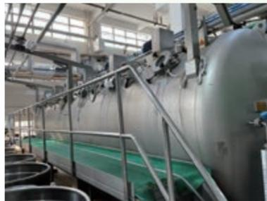
染布為生產針織布過程中其中一個消耗水資源最多的工序。有見於此，番禺廠一直嘗試循不同渠道減少染布用水，如優化工序、提升技術等。近年，番禺廠採購先進的新型低浴比水流染缸以取代舊染缸。低浴比水流染缸較傳統的水流染缸色浴比低約40%
