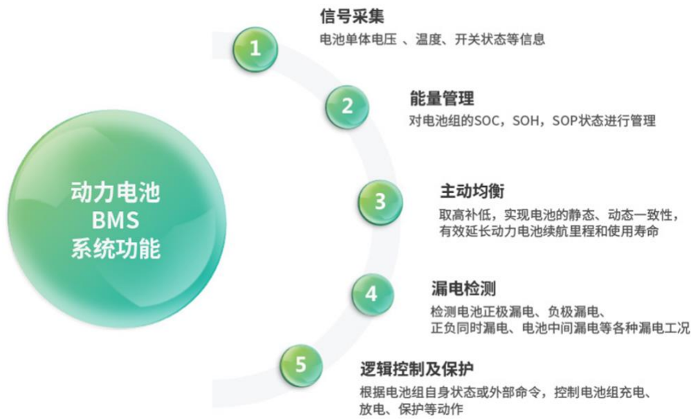
动力电池 BMS 系统的功能图
