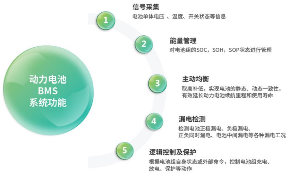
动力电池 BMS 系统的功能图
