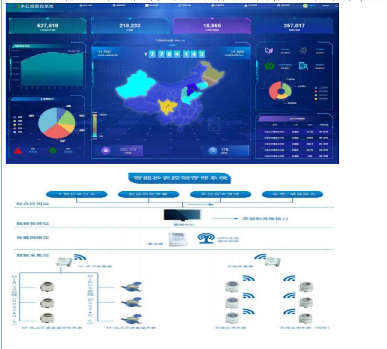
“丰源水在线智控系统”具有简单易用、优质的通信（采用 NB-IoT、LoRa 等通信模块）、低功耗设备（以超声波远传水表为例，电池使用时长为 6 年以上，低电量报警后可正常工作 180 天以上）等特点。
