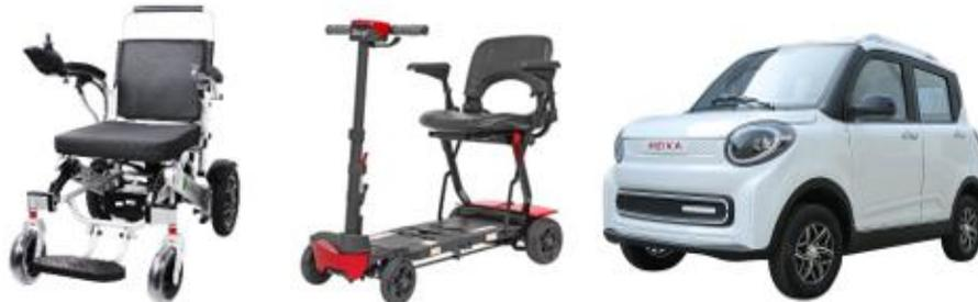
可折叠轮椅式代步车受众群体基本是特殊残疾人群，根据国家医疗器械标准要求电动轮椅车速应严格控制在6km/h内，作为基本日常外出的代步工具，客户对产品的性能关注点主要是结构牢固、行走平稳、安全以及易于操作。
