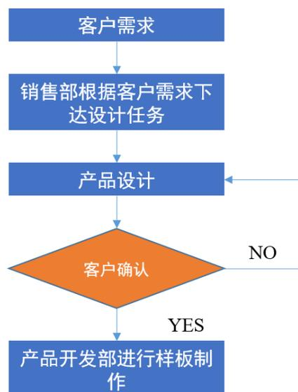
公司为客户提供个性化定制产品，根据客户订单进行外观、结构及工艺设计。公司产品设计的基本流程为：销售部根据客户的需求下达产品设计任务；产品开发部对产品外观进行设计并按照客户提供的技术参数进行产品结构及工艺设计；在数据和图纸经过客户确认后，产品开发部根据设计方案制成样板。
