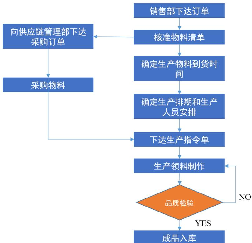
公司生产的基本流程为：销售部与客户签订销售合同后，向订单运作部下达正式订单；产品开发部核准物料清单，订单运作部确定生产物料需到货的时间、生产排期和生产人员安排；随后订单运作部向供应链管理部下达采购申请，采购物料；生产人员下达生产指令单，生产领料制作；生产完成后交予品质管理部进行检查，通过检查后将成品交予仓库。
