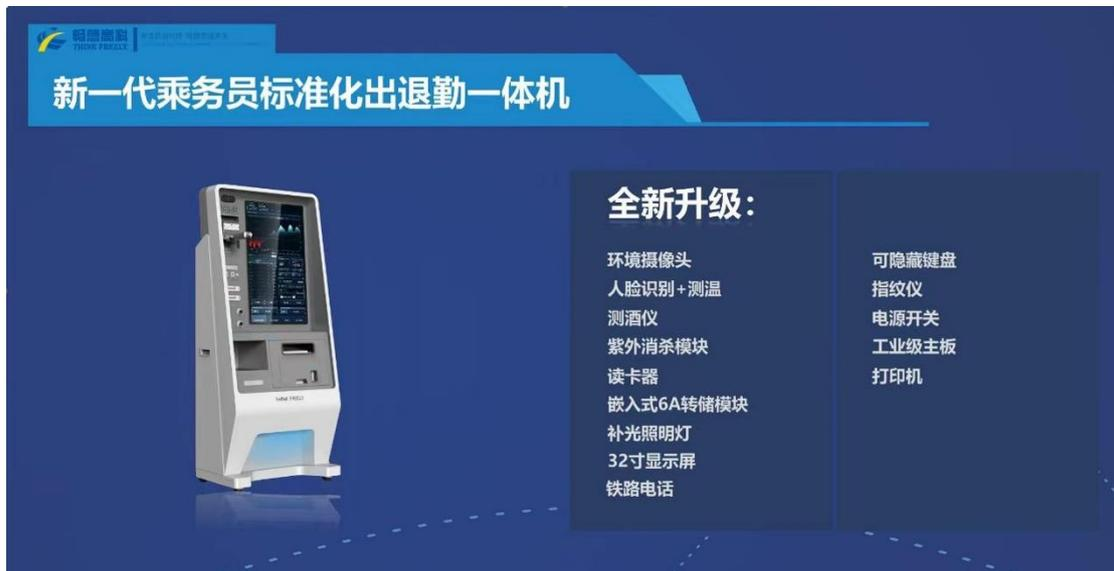
如上图所示，公司在一体机内集成了工控主机、指纹识别、虹膜识别、酒精检测、IC卡写卡验卡、影像采集、体温检测和视频转储打印等功能模块。上述功能模块，需要在硬件功能层面、软件功能层面进行整合，需定制化采购：
