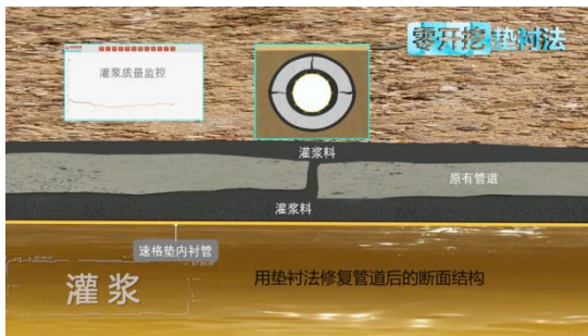
⑨垫衬法修复管道后纵向截面图
