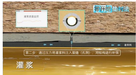
⑥对原有管道结构补强
