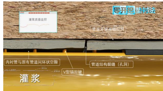
④原有管道缺陷
