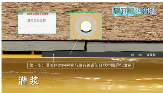
⑤管道内壁破损修复
