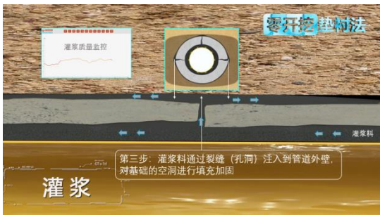
⑦对原有管道外壁空洞进行填充 (基础加固)
