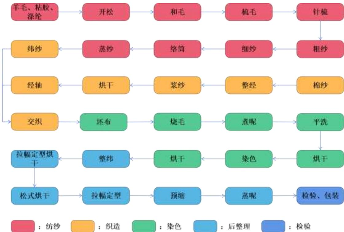
发行人衬布生产工艺流程包括“纺纱—织造—染色—后整理”，实现产品形态
