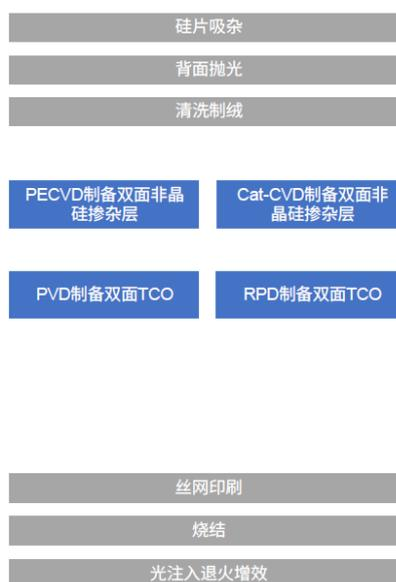
在非晶硅层沉积方面，PECVD 优点是沉积速度快、膜均匀性好，缺点是等离子体对硅片表面产生轰击。CAT-CVD 是利用高温热丝催化作用使  $\text{SiH}_4$  分解从而制备硅薄膜，优点是对界面轰击较小，薄膜质量好，硅片钝化效果好，但是其均匀性较差，且维护成本较高。目前来看，PECVD 设备为市场主流，国内的理想万里晖、福建钧石、捷佳伟创、迈为股份都实现了该设备的量产能力。非晶硅沉积设备占 HJT 设备总成本的比重在 50%左右，降低 PECVD 设备成本、提高设备生产能力对于降低设备总成本意义重大。
