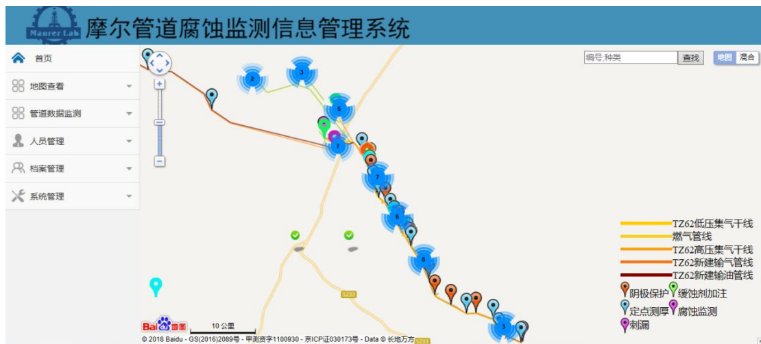
管道腐蚀监测信息管理系统示意图
