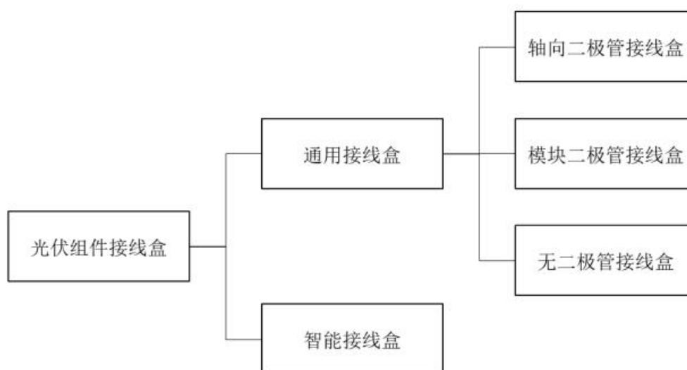
根据光伏组件接线盒是否包含智能芯片模块，可分为通用接线盒和智能接线盒。通用接线盒不包含智能芯片，主要功能包括连接、自动保护功能；智能接线盒通过智能芯片实现更为多样的功能，属于组件级电力电子技术，除了连接、自动保护功能外，还能够对光伏组件实现发电效率智能优化、智能关断、智能监控等精细化控制功能。目前市场以通用接线盒为主，智能接线盒为辅。
