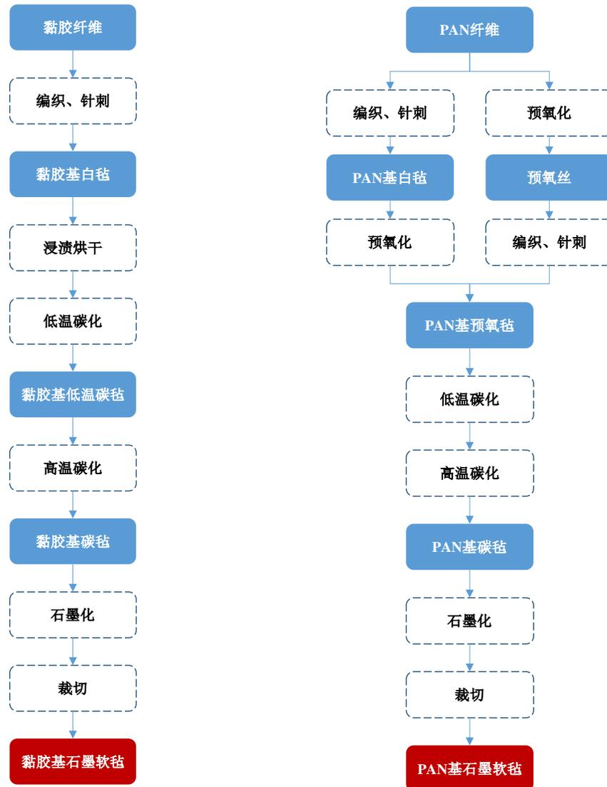
注：图中蓝色方框为原材料，红色方框为产品，虚线方框为主要生产工序。
