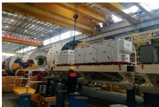
TBM 隧道掘进机（工程机械）
