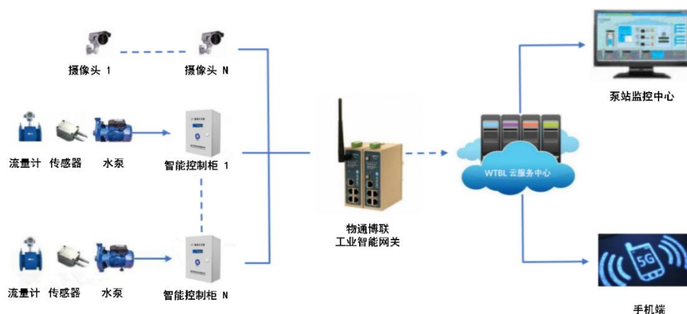
图：公司的泵站智能运维管理系统原理图
