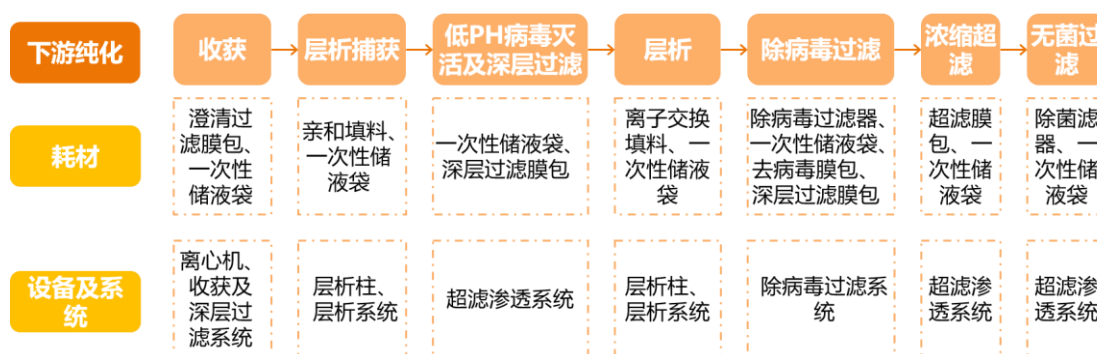
生物药分离纯化流程示意图
