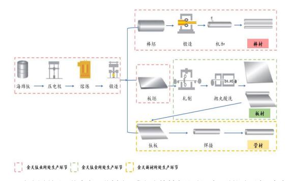
由上图所示,从生产环节划分,发行人棒材产品需经过下游锻造厂商、机加厂商进行加工后向军工集团进行销售。发行人棒材产品与金天钛金板材、金天新材管材产品在生产环节上不构成上下游关系。发行人仅有板坯产品位于金天钛金、金天新材产品的上游生产环节。发行人的纯钛产品绝大部分是销售给金天钛金的锻坏(纯钛板坏),是金天钛金板材产品的上游材料,金天钛金需要经过轧制等关键工艺加工后方能成为板材。
