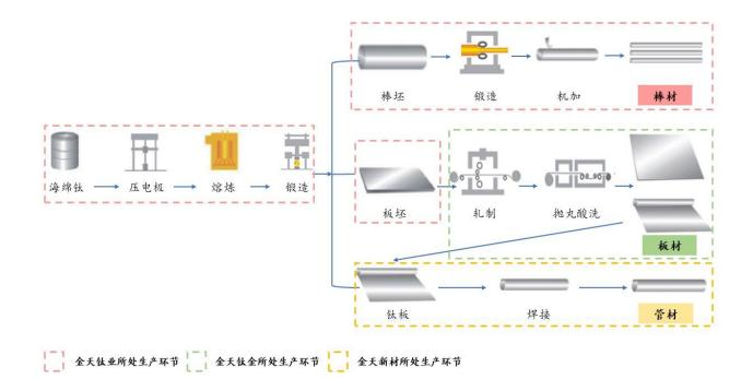
由上图所示,从生产环节划分,发行人生产棒材关键工序在熔炼和锻造;金 天钛金生产板材的关键工序在轧制;金天新材生产钛及钛合金管材的关键工序在 焊接。金天钛业的关键生产设备主要为熔炼和锻造设备,而该类设备金天钛金、 金天新材并未配置。
