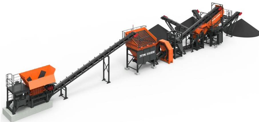
RAP 柔性破碎筛分设备图示（RPS 系列）
