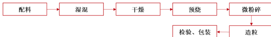
软磁铁氧体粉料生产工艺流程图（干法）
