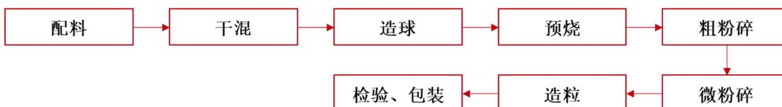
软磁铁氧体磁心生产工艺流程图
